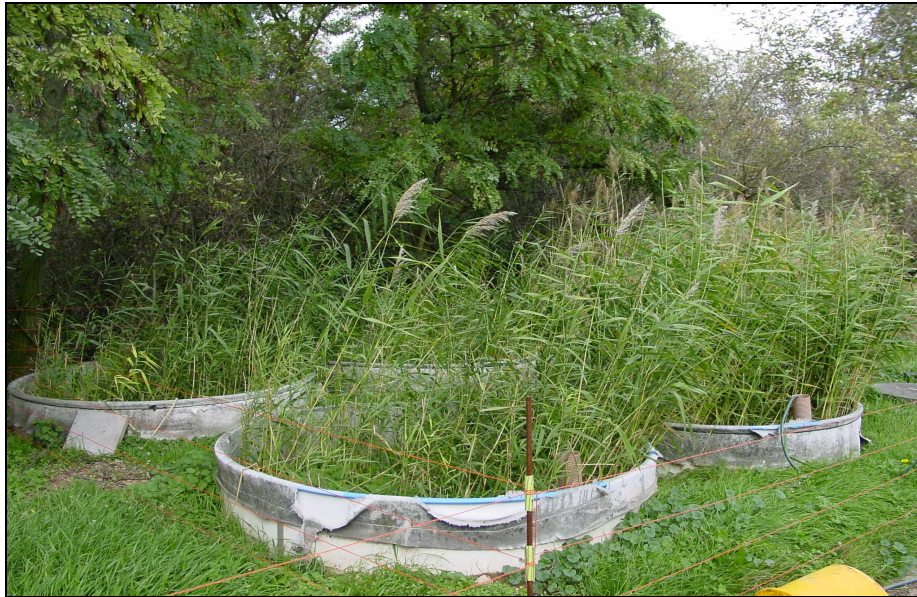
Bild 1: Aufbau der Schilfkläranlage (27.10.2006)
